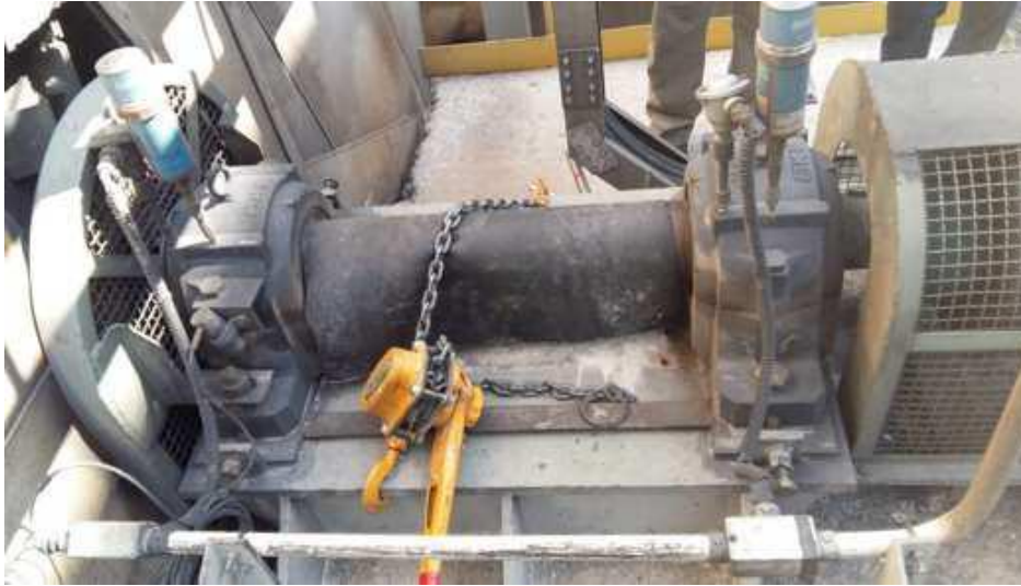
Figura 2: Catraca instalada no eixo do acionamento do exaustor
