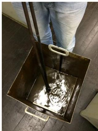
Resfriamento em água após remoção do forno elétrico á 960°C. (Figura 3)
