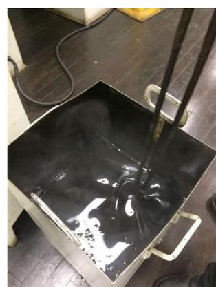
Resfriamento em óleo após remoção do forno elétrico á 960°C. (Figura 4)
