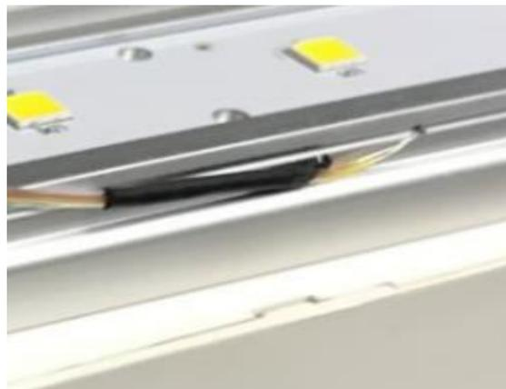
Figura 20 – Posição do termopar 14 no dissipador - Fonte: Unicoba (2018).
