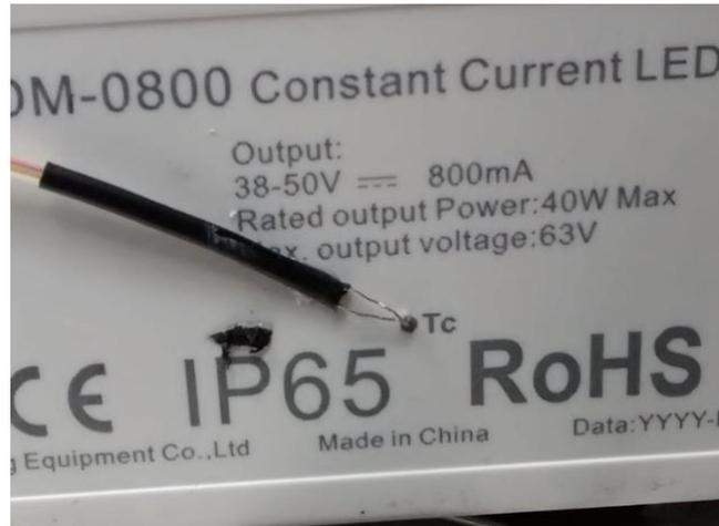
Figura 18 – posição do termopar número 16 na fonte de 40W - Fonte: Unicoba (2018).
