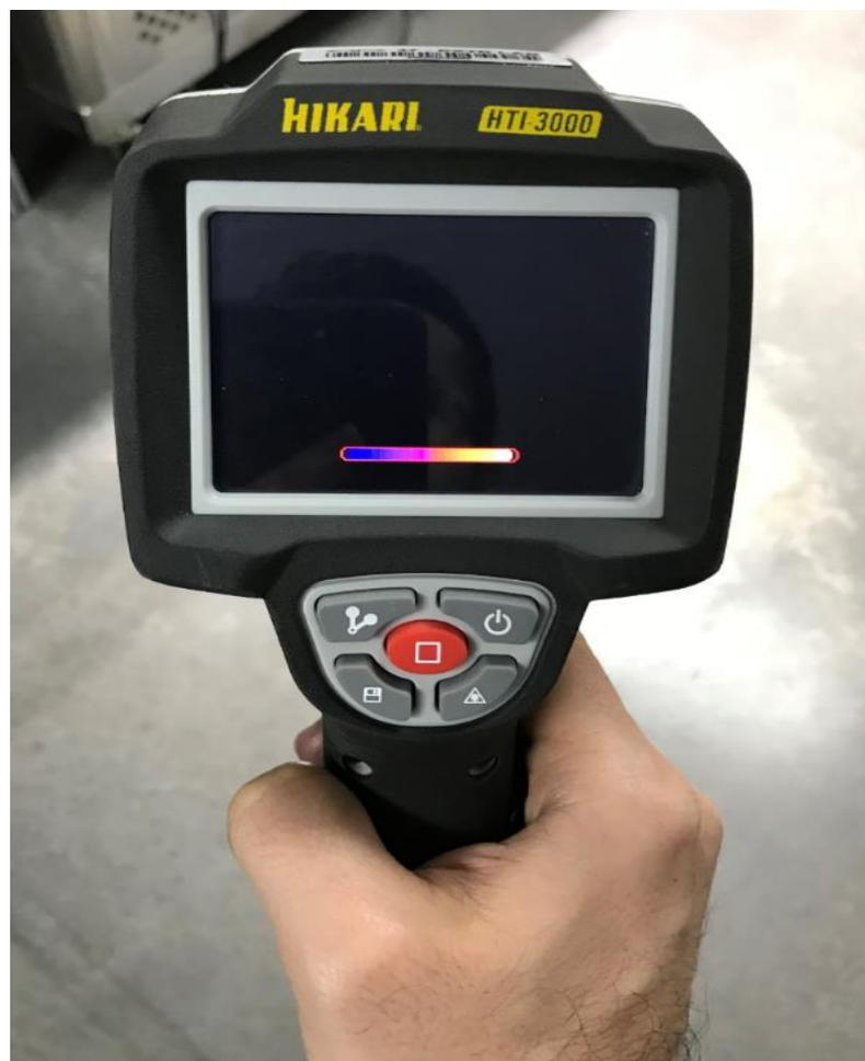
Figura 10 - Termovisor - câmera termográfica modelo HTI 3000 - HIKARI ® Fonte – Unicoba (2018).
