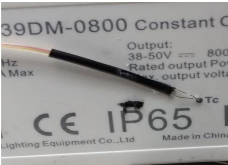
Figura 8 – Termopares tipo K - Fonte – Unicoba (2018).
