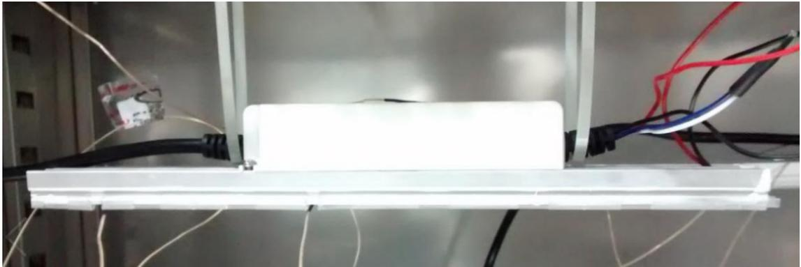
Figura 9 - Luminária LED linear 40W com 10 LEDs montados e fonte
