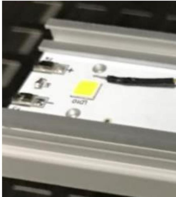
Figura 19 – Posição do termopar 5 próximo ao LED denominado LD10 - Fonte: Unicoba (2018).
