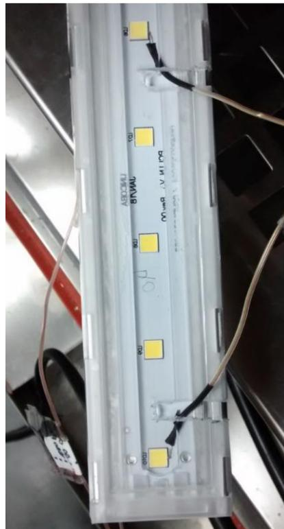
Figura 24 – Termopares instalados nos LEDs 6 e 10 - Fonte: Unicoba (2018).
