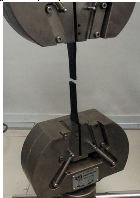
Figura 9 - Corpo de prova ao término do ensaio
