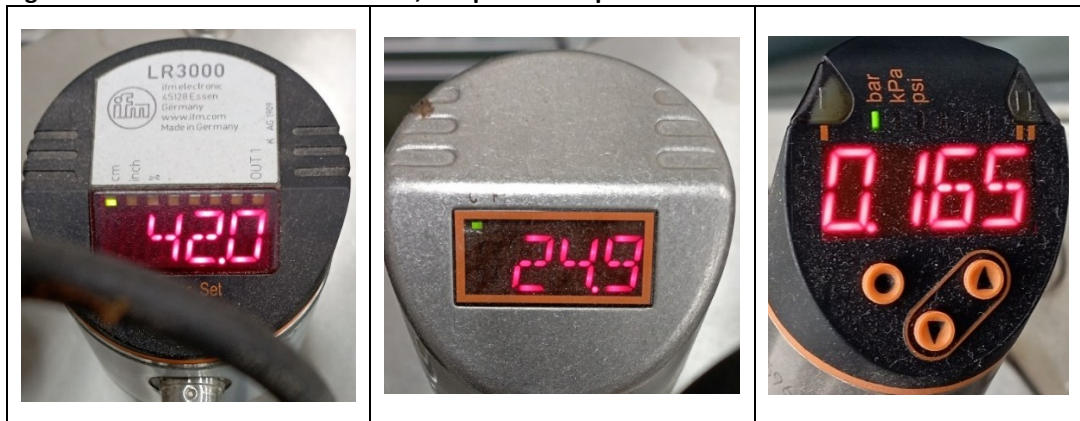
Figura 14 - Sensores IO-Link denível, temperatura e pressão.
