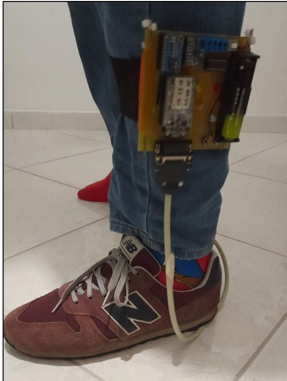
Figura 8 - Palmilha conectada ao coletor de dados
