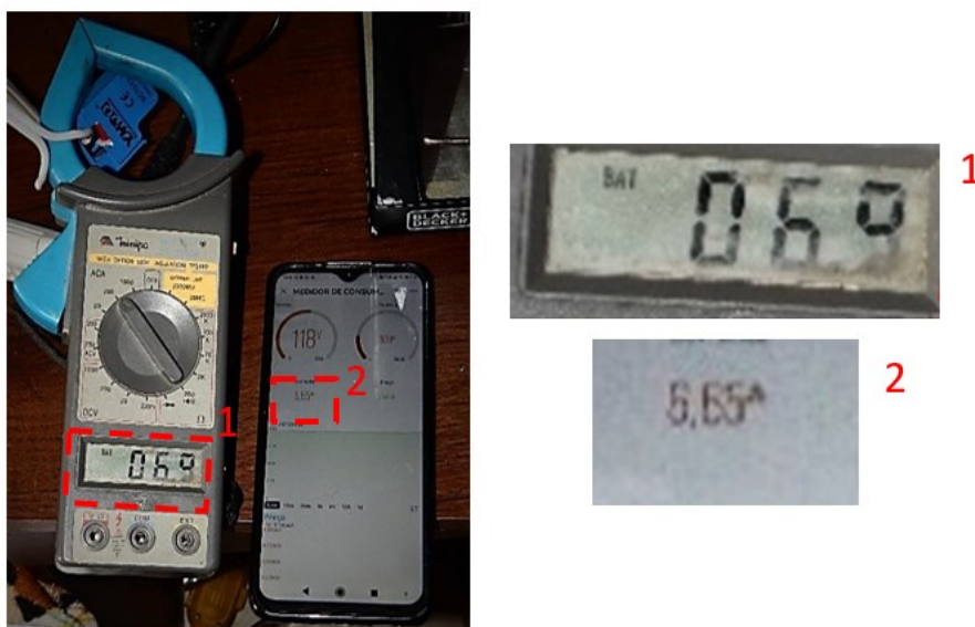
Figura 8 - Comparação entre a corrente do amperímetro e protótipo
