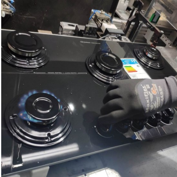
Figura 11: Teste de variação de força do manípulo manual
