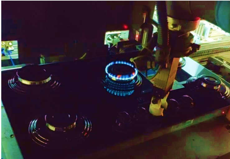
Figura 14: Teste de variação de força vazão mínima
