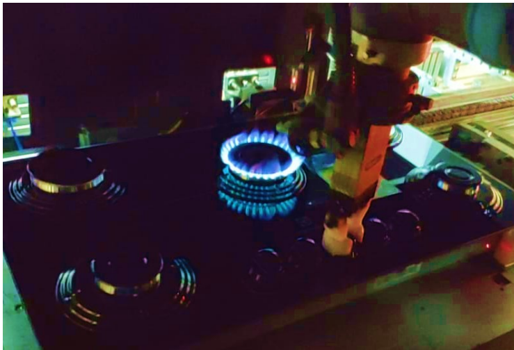
Figura 15: Teste de variação de força vazão máxima
