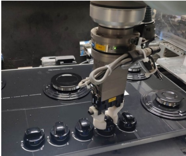
Figura 13: Teste de variação de força com robô
