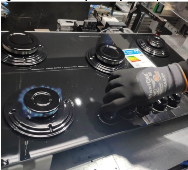
Figura 10: Teste de variação de força do manípulo manual
