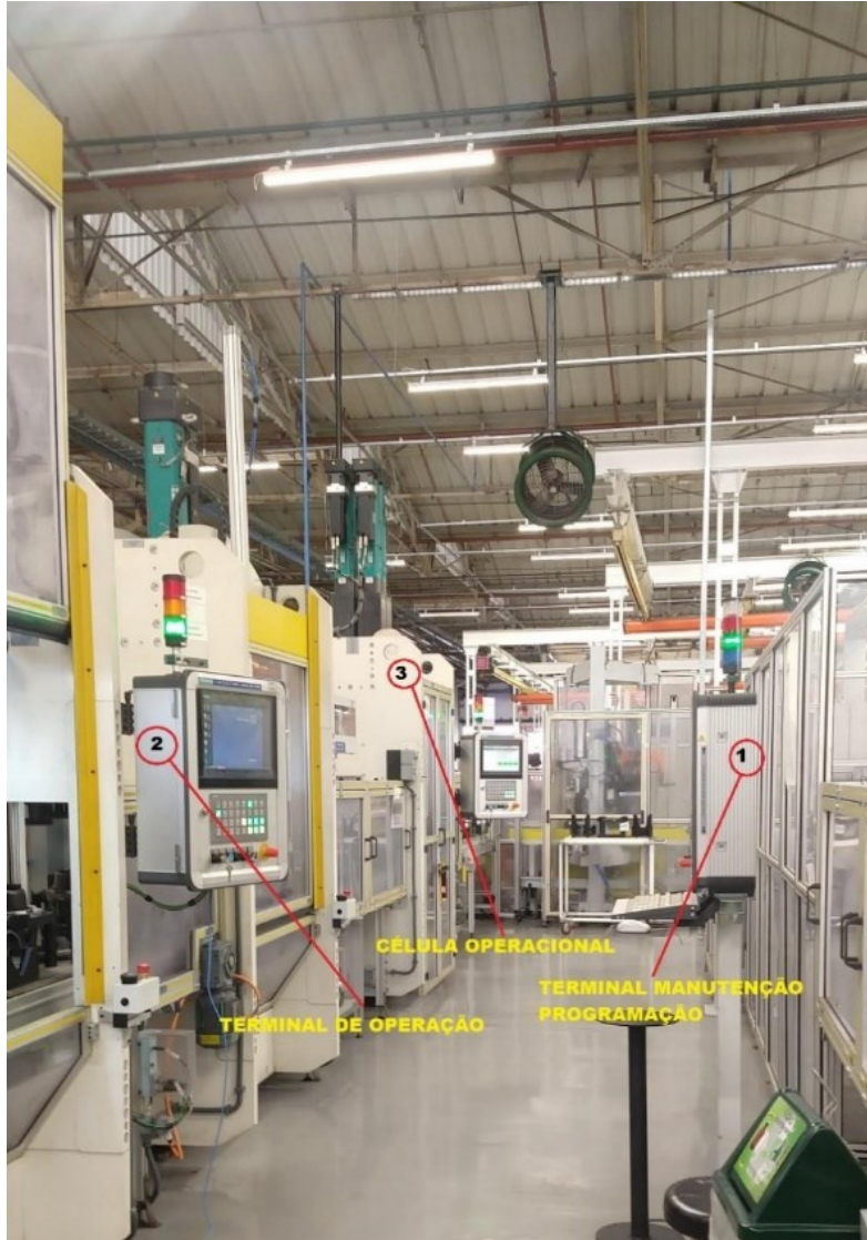
Figura 4 – Organização da linha de pré-montagem
