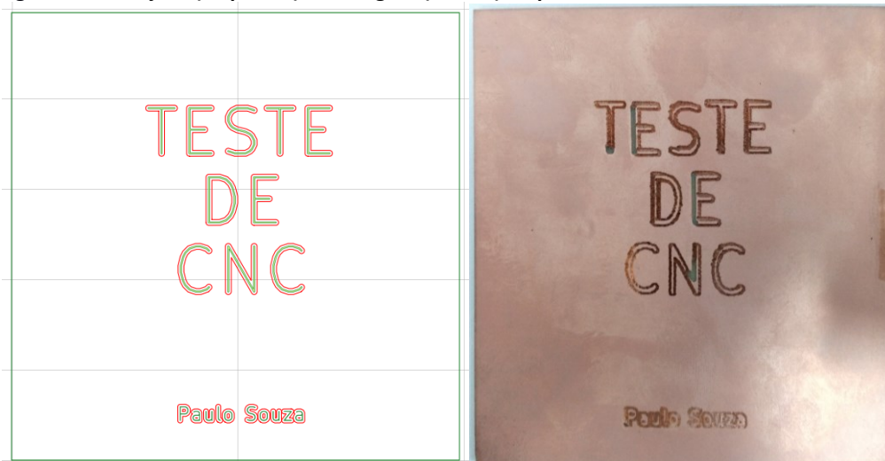
Figura 10 – Projeto (esquerda) e usinagem (direita) da placa
