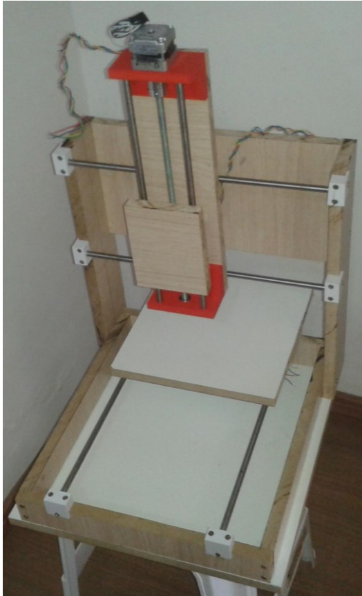
Figura 3 – Montagem da nova estrutura mecânica
