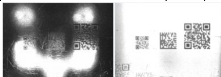
Figura 20 - Leitura sem e com difusão de luz em superfícies espelhadas
