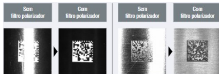
Figura 19 - Leituras sem e com polarizador.
