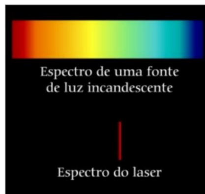
Figura 1 - Comprimento de onda de uma luz incandescente e do laser
