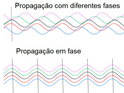
Figura 2 - Diferença entre propagação em fase e fora de fase
