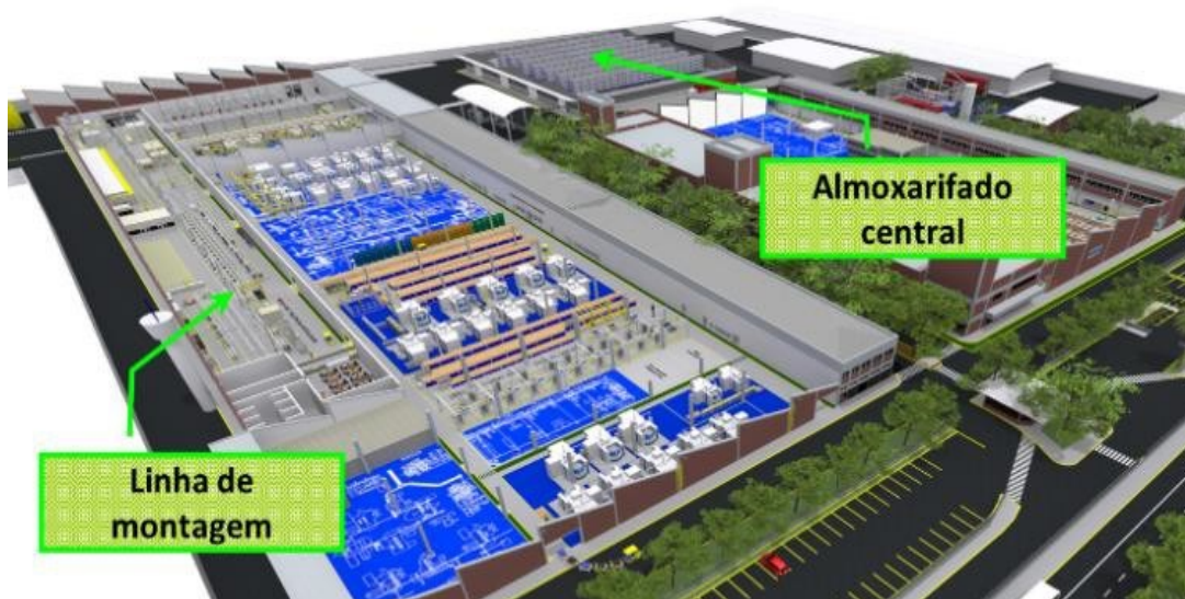
Figura 11. Planta 3D da MWM e representação da distância existente entre o almoxarifado de peças e a linha de montagem
