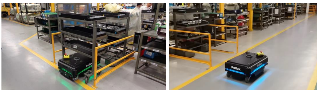
Figura 20 – AMR realizando o abastecimento de Kits em uma linha de montagem
