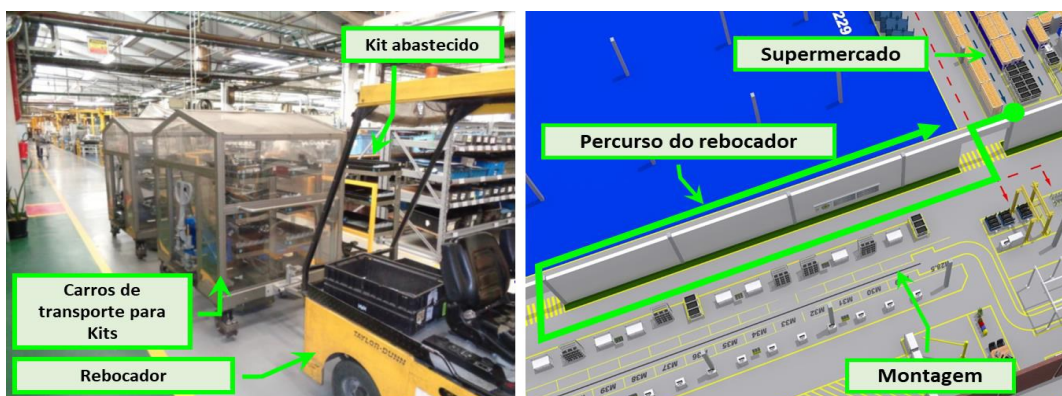
Figura 18 – Kits de peças transportados por rebocadores. Neste processo, cada carro de transporte leva 2 kits internamente
